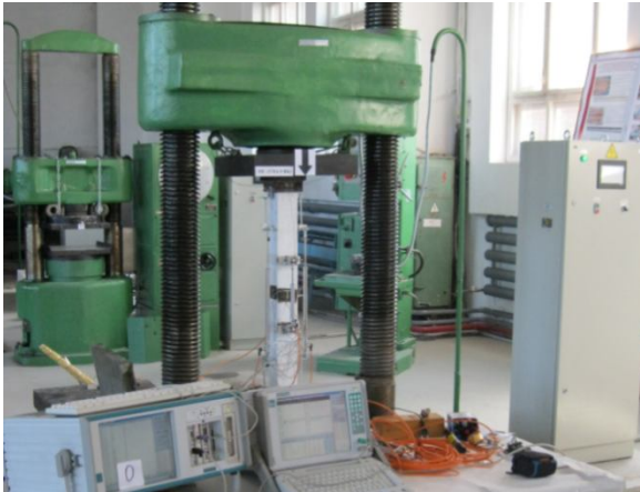
Рис. 2. Общий вид испытания экспериментальных образцов на сжатие
