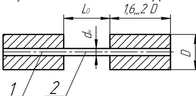
1 – испытательная муфта; 2 – отрезок стержня
