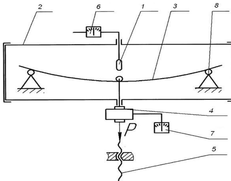
1 – термометр сопротивления; 2 – нагревательная камера; 3 – образец; 4 – силоизмерительный датчик; 5 – нагружающий винт; 6 – система измерения температуры; 7 – система измерения силы; 8 – опоры нагружающего механизма
