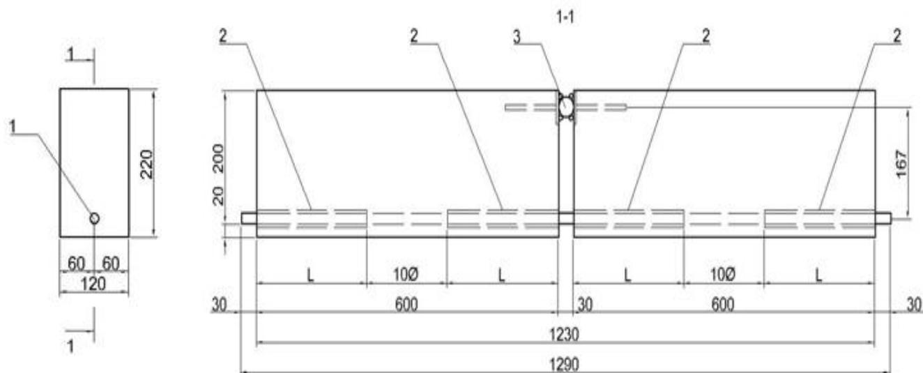
1 - стержень; 2 - поливинилхлоридная трубка; 3 - стальной цилиндр
