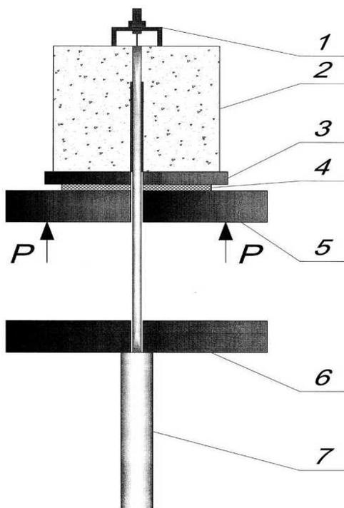
1 – измеритель проскальзывания на свободном конце стержня; 2 – образец; 3 – опорная плита; 4 – мягкая прокладка; 5 – подвижная траверса испытательной машины; 6 – неподвижная траверса испытательной машины; 7 – испытательная муфта
