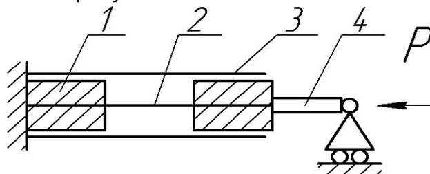
1 – испытательная муфта; 2 – отрезок стержня; 3 – направляющая втулка; 4 – плунжер
