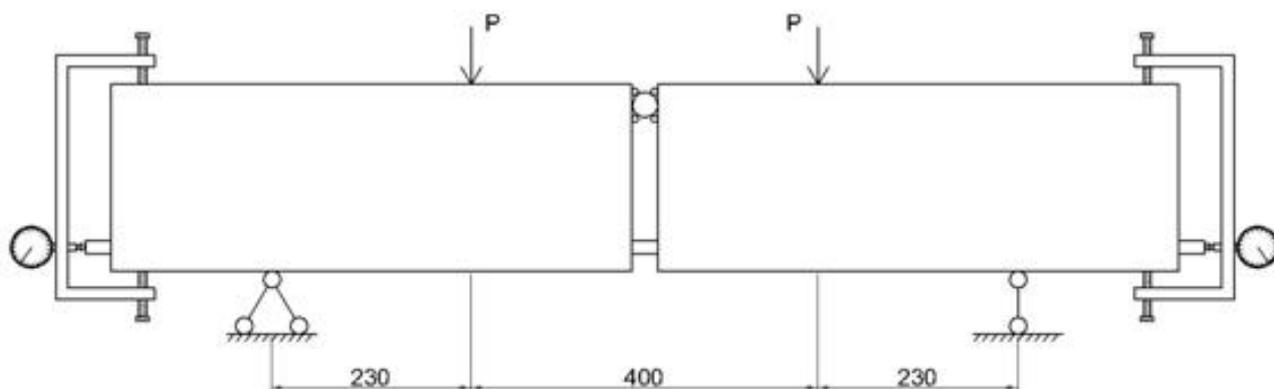
Рисунок Д.4 – Схема испытания образца изгибом балки
