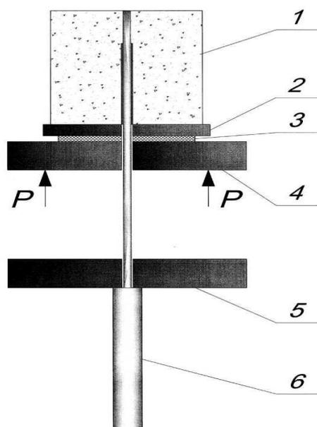
1 – измеритель проскальзывания на нагруженном конце стержня; 2 – образец; 3 – опорная плита; 4 – мягкая прокладка; 5 – подвижная траверса испытательной машины; 6 – неподвижная траверса испытательной машины; 7 – испытательная муфта
